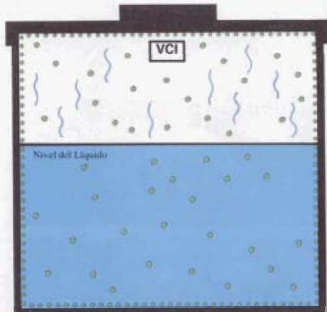
Tanque mostrando el proceso de protección activa VCI en las tres fases: fase líquida, interfase y vapor.
