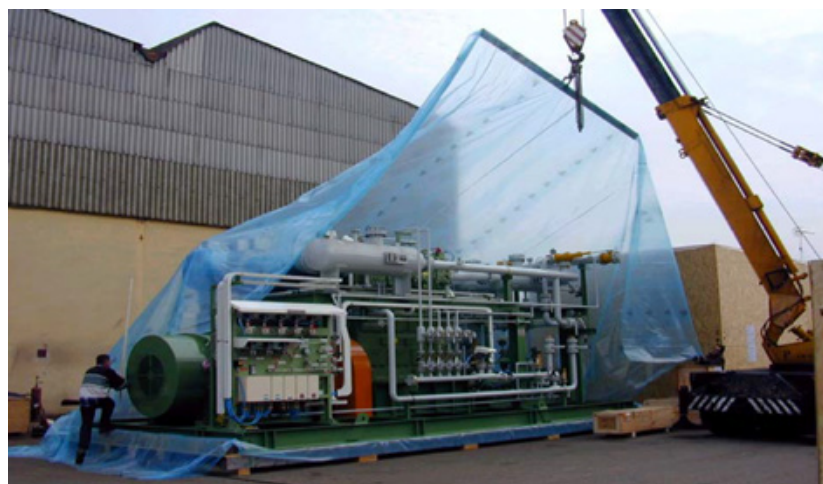
FIGURA 9. Aplicación de film VCI en equipo de grandes dimensiones
